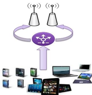
*Load Balancing su due connessioni dati attive contemporaneamente*
